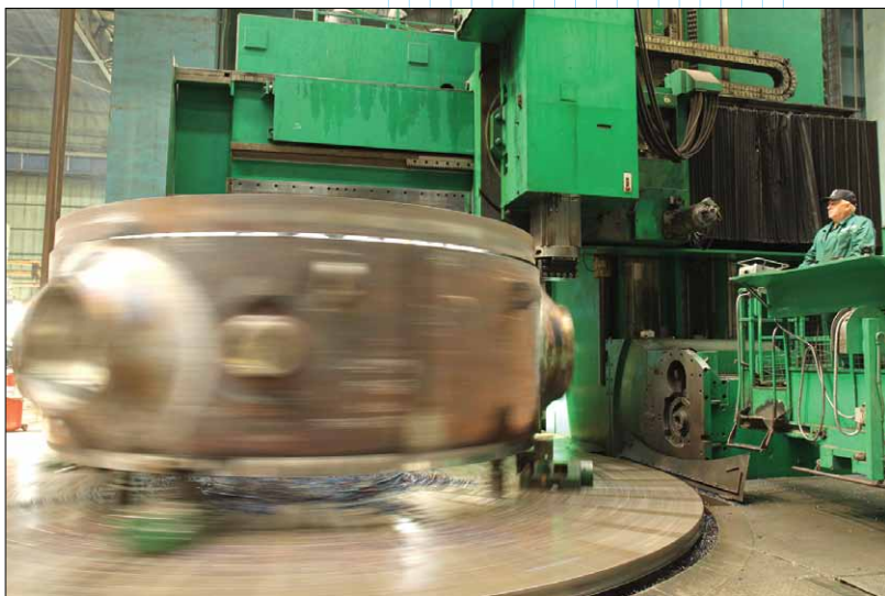
Механическая обработка обечайки зоны патрубков корпуса реактора для Белорусской АЭС
