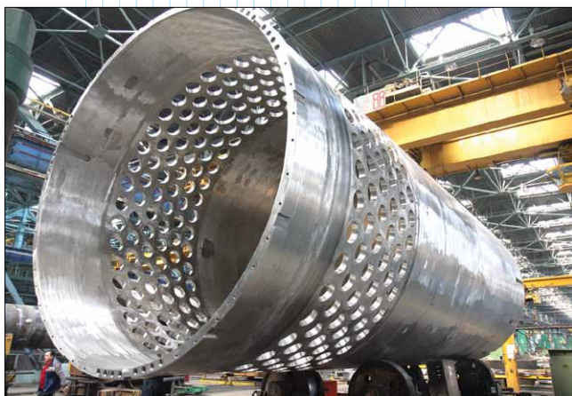
Шахта внутрикорпусная корпуса реактора ВВЭР-1200
