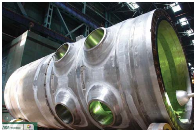
Корпус ядерного реактора ВВЭР-1000
