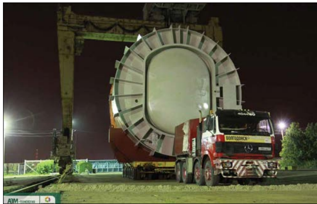
Корпус шлюза транспортного на специализированном причале
