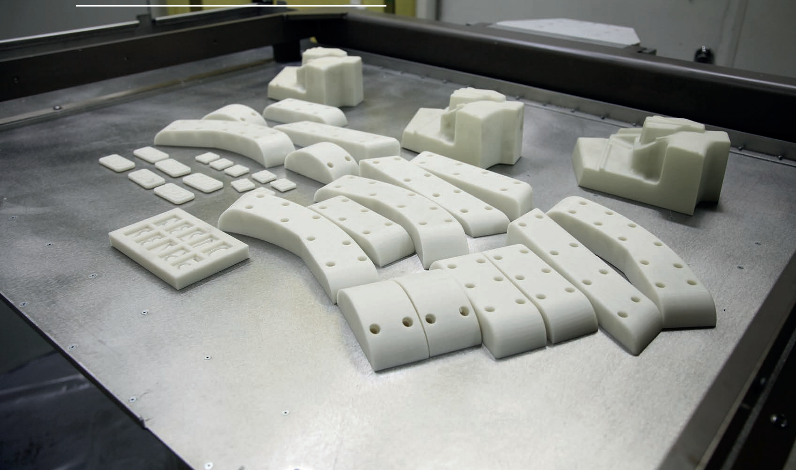
3D-принтер гарантирует высокое качество печати – толщина каждого из слоев составляет от 0,05 до 0,15 мм
