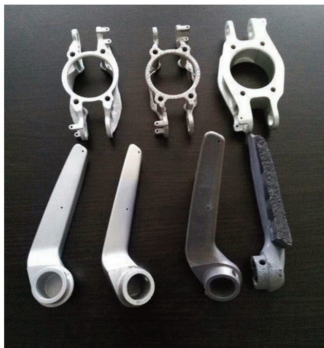
Ползун управления хвостовым винтом вертолета Ансат, напечатанный на 3D-принтере
